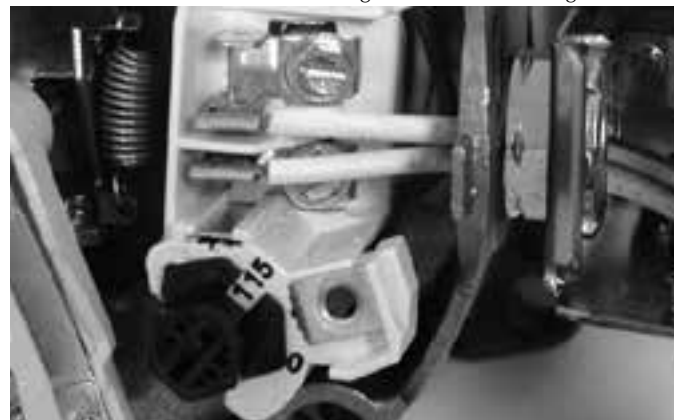
Figura 11: Tensión configurada para 115 V, tipo cuadrante.
